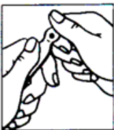
Abb. 1 Unterhalb des Punktes ist die Sollbruchstelle.
